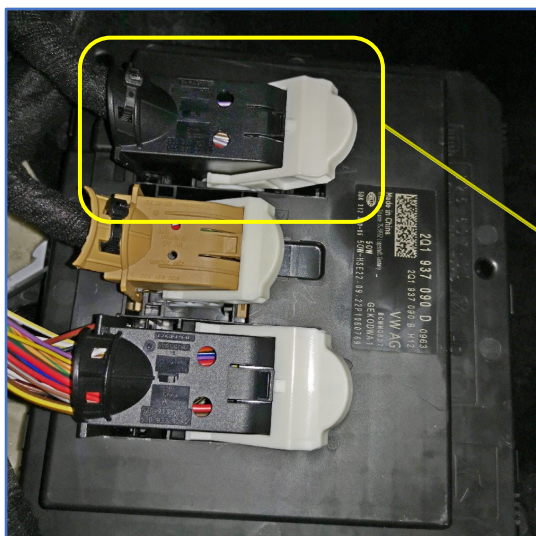
Рис. 5.1 и 5.2. Разъём А блока VCM (чёрный с чёрной вставкой) СЛЕВА от рулевой колонки
