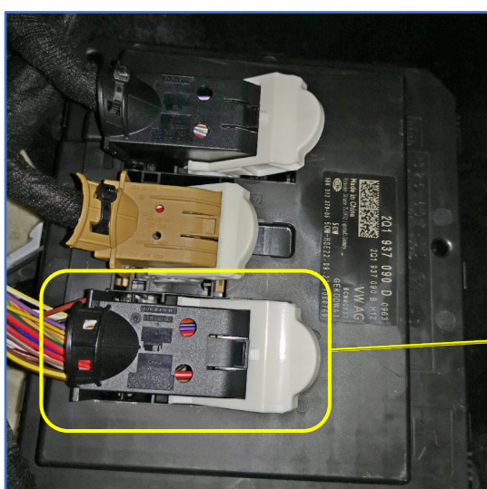
Рис. 3.3 и 3.4. Разъём С блока ВСМ (чёрный с белой вставкой) СЛЕВА от рулевой колонки
