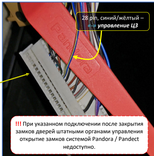
Рис. 3.7 и 3.8. Разъём С блока VCM (чёрный с белой вставкой) СЛЕВА от рулевой колонки
