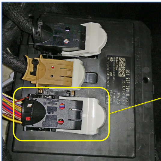
Рис. 3.7 и 3.8. Разъём С блока VCM (чёрный с белой вставкой) СЛЕВА от рулевой колонки
