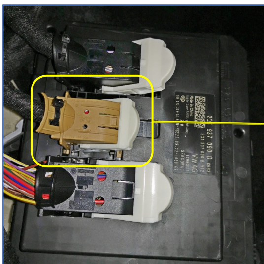
Рис. 4.1 и 4.2. Разъём В блока VCM (коричневый) СЛЕВА от рулевой колонки
