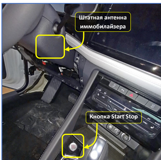
Рис. 1.3. Точки подключений на рулевой колонке и в центральной панели.
