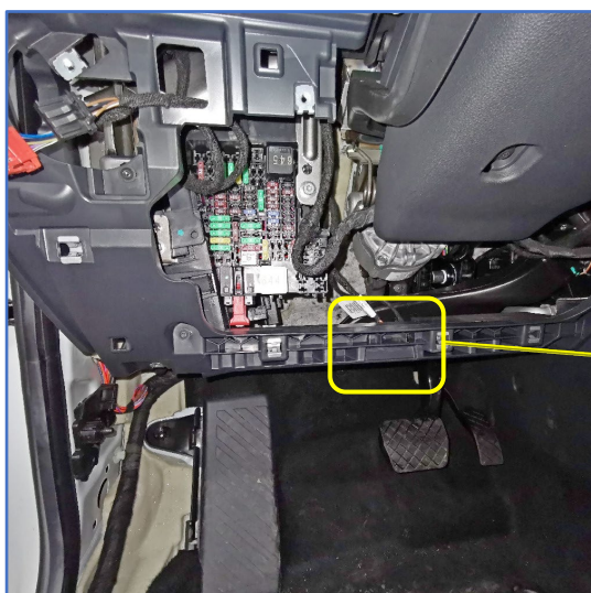
Рис. 6.1 и 6.2. Разъём OBD ПОД рулевой колонкой
