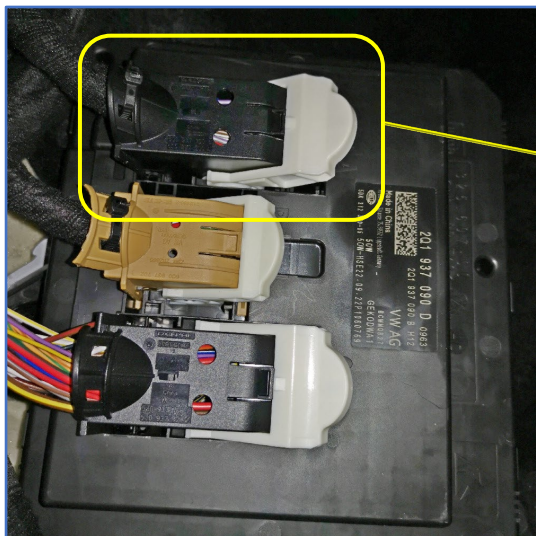
Рис. 5.3 и 5.4. Разъём А блока ВСМ (чёрный с чёрной вставкой) СЛЕВА от рулевой колонки
