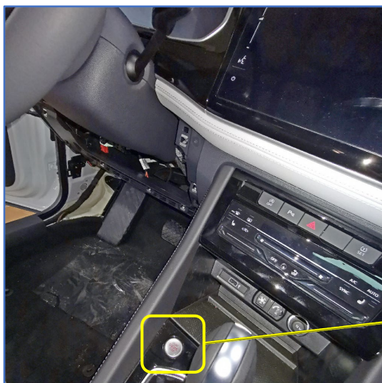
Рис. 7.1 и 7.2. Разъём кнопки Start Stop (чёрный) на центральной панели
